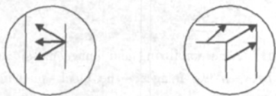
图3 孔径问题:如果块中只包含单一方向直线,如左图所示,我们只能确定与边缘线垂直方向上的位移矢量,水平方向上的位移矢量却不能确定
