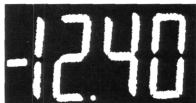
图 3.2 采用自适应阈值的二值化图像
