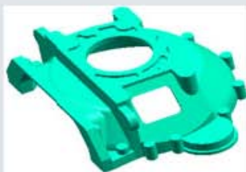
图1 离合器壳铸件模样
