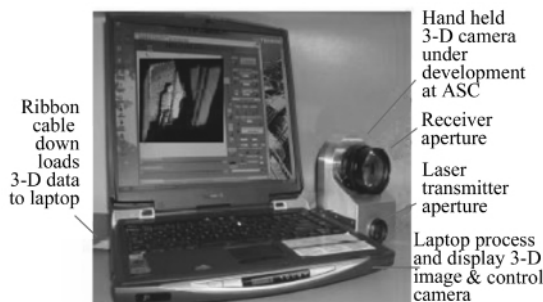
图 1 激光 3D 成像雷达的原型样机
