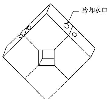
(b) 光学积分器冷却水口示意图
