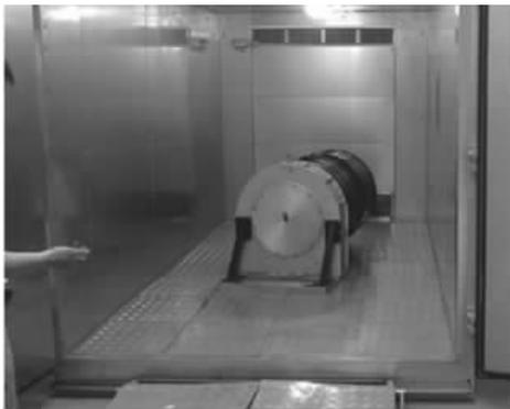
图2 碳纤维连接筒湿热试验
