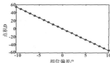
图 9 相位与点积的关系曲线
