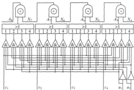
图 3 硬件逻辑译码电路图
