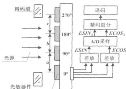
图 7 莫尔条纹细分硬件示意图
