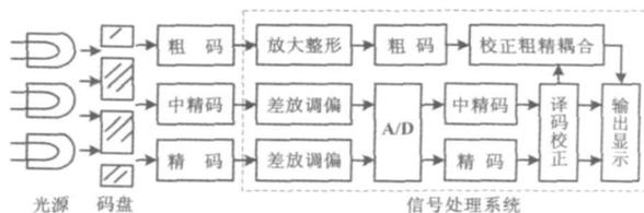
图 1 光电编码器信号处理框图
