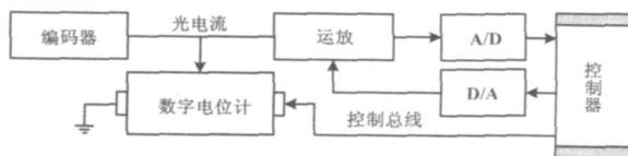
图 6 幅值闭环控制补偿原理图
