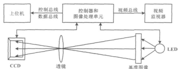
图 10 图像编码器组成原理框图
