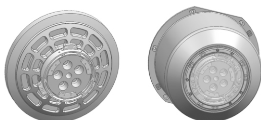
(a) 反射镜支撑 (b) 反射镜组件 (a) Mirror mount (b) Mirror assembly
