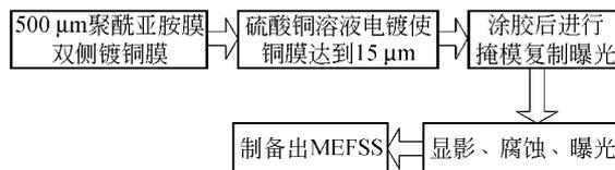
图 9 MEFSS 制备工艺流程
