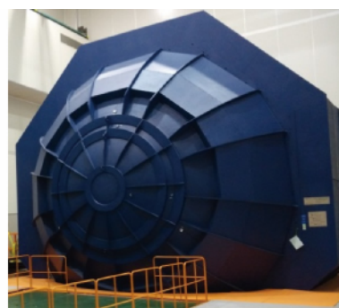
图 4 8 m 积分球辐射定标光源
