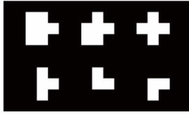
图 4 0^\circ 方向的结构元素能够检测出的候选点形态
