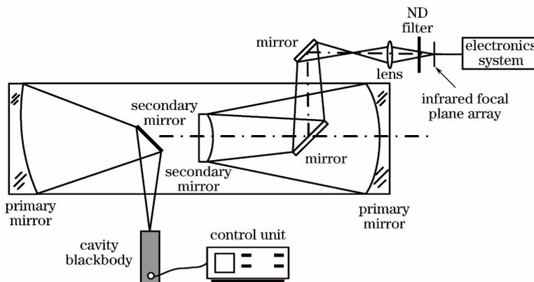
图 5 平行光管法实验装置原理图
