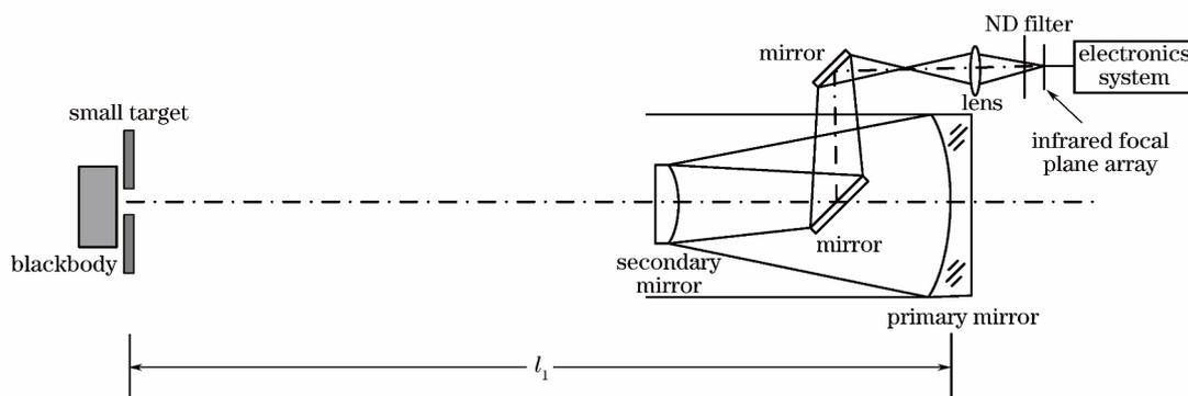
图 6 小目标辐射特性测量原理图
