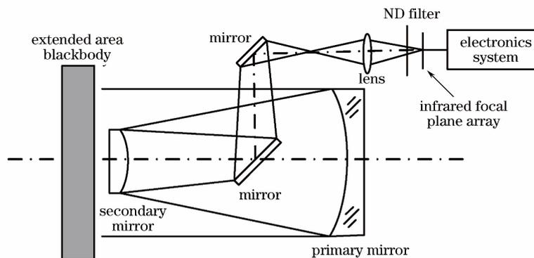
图 4 近距离扩展源法实验装置原理图
