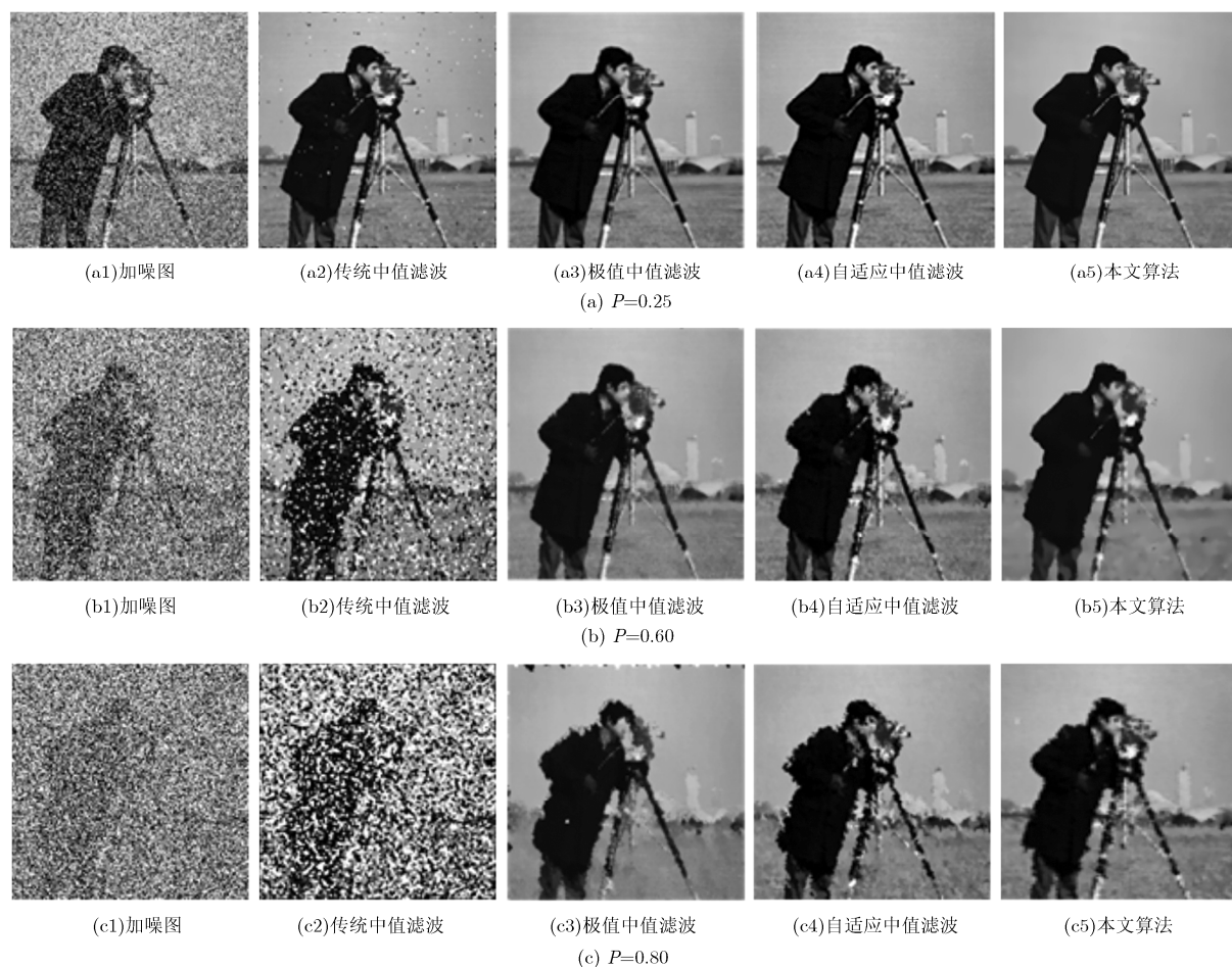
图2 不同噪声强度下各种去噪算法处理结果对比图
