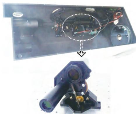
图8 可见光电视系统及镜组切换机构的实物
