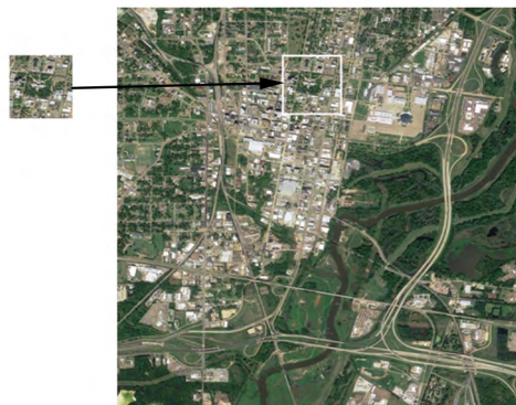
图 6 3 种归一化互相关算法的匹配结果示意,右图实时图尺寸为 150 \times 150 ,左图为右图在 512 \times 512 基准图上的匹配结果
