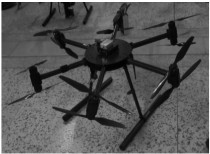
图 2 Hex-Rotor 无人飞行器原型机 Fig. 2 Prototype of Hex-Rotor UAV
