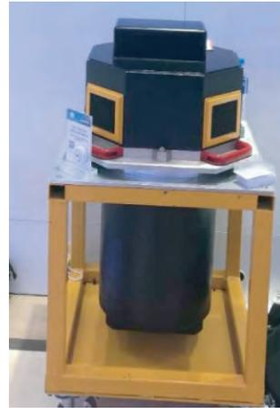
图 12 大视场三线阵航空测绘相机实物照片
