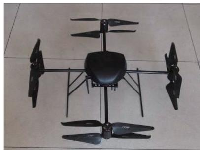
(a) 地面共轴八旋翼原型机
