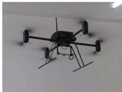
(b) 空中共轴八旋翼原型机
