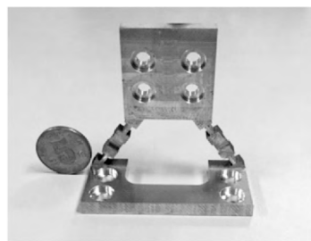
图 5 Bipod 柔性支撑结构
