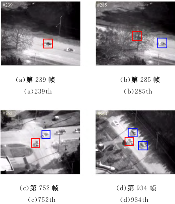
图 4 红外车辆跟踪结果 Fig. 4 Infrared tracking results of cars
