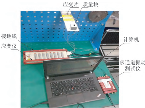
图 8 喷嘴推力测试标定实验平台 Fig. 8 Nozzle thrust calibration test platform
