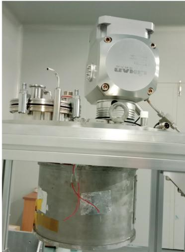
图 4 空间低温绝对辐射计样机
