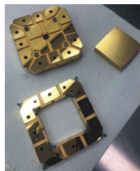
图 9 加工完成后的电极件和 TM
