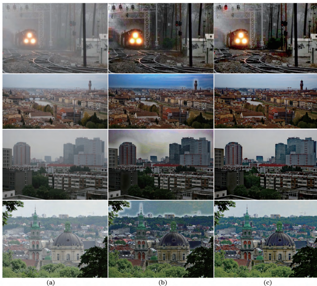
图 5 去雾结果对比。(a)雾天图像;(b)暗通道先验算法的结果;(c)所提算法的结果
