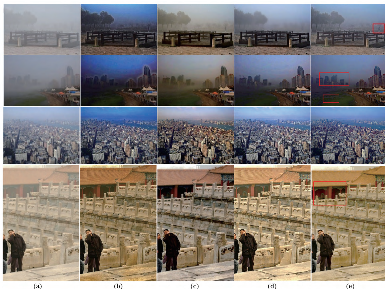
图 6 图像去雾对比结果。(a)雾天图像;(b)暗通道先验算法;(c) Kim 算法;(d) Bi 算法;(e)所提算法
