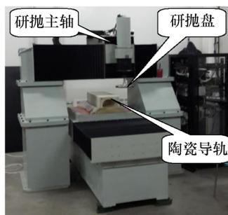
图1 数控超精密研磨抛光机
