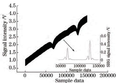
图 7 两个吸收峰的吸收光谱信号
