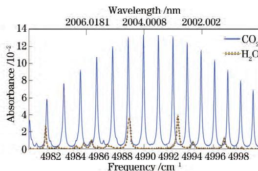
图 1 CO<sub>2</sub> 气体在 2004 nm 附近的模拟吸收光谱
