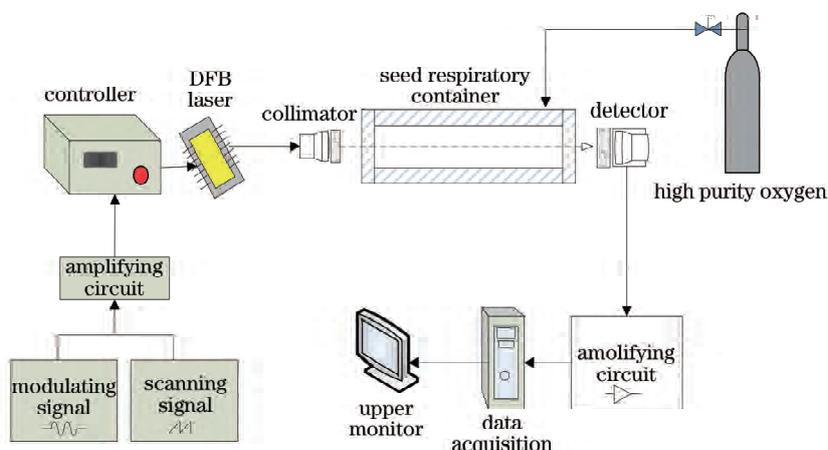
图 4 波长调制 TDLAS 实验系统结构图
