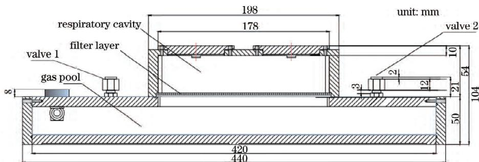
图 2 基于多次反射池的种子呼吸 CO<sub>2</sub> 浓度检测池的结构原理图
