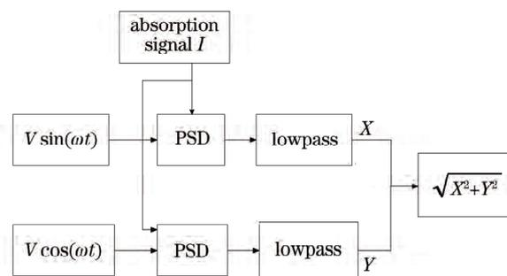
图 6 正交矢量二次谐波信号解调算法结构框图
