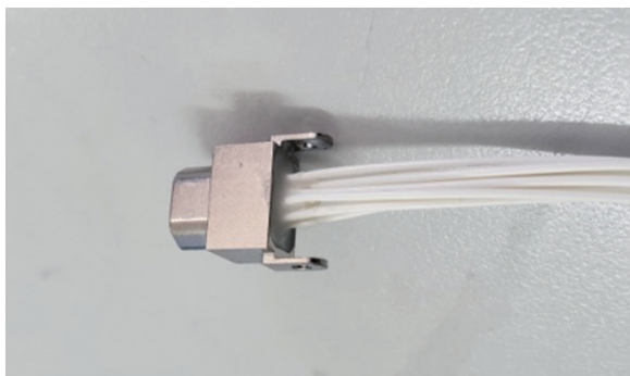
图 10: 灌封后 J30J 压接微矩形电连接器
