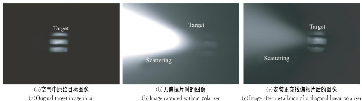
图 5 有/无偏振片采集到的图像对比
