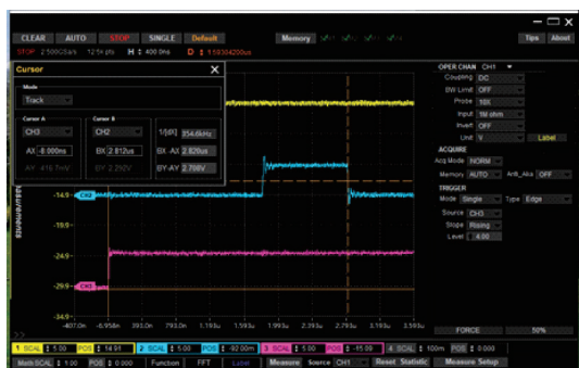
图8 外触发信号到CCD曝光开始时间差
