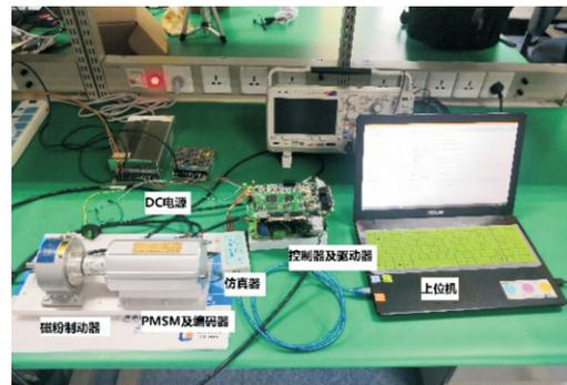
图13 PMSM实验平台
