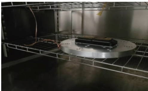
图 14 焦面组件高低温循环试验
