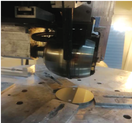
图2 MRF160磁流变抛光装置实物图
