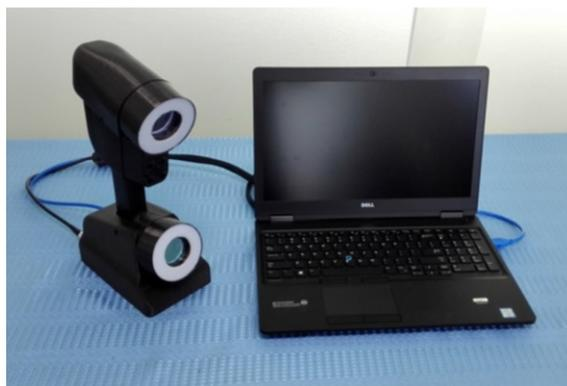
图 4 手持式三维激光扫描设备
