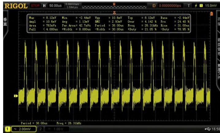
图6 室温下，泵浦功率为4.5W时，SESAM被动调Q的VECSEL输出的脉冲波形
