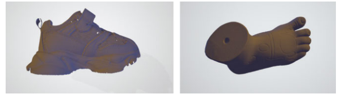
图5 鞋子点云配准拼接结果 图6 足部模型点云配准拼接结果
