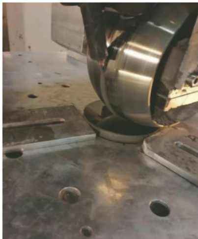
图 5 去除函数测试加工图
