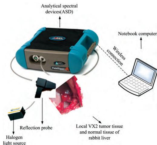
图 1 用于测量兔肝 VX2 肿瘤组织和正常组织的实验装置
