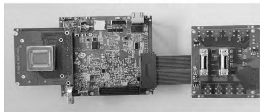
图 1 高帧频成像系统结构框图与系统实物图
