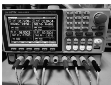
图 5 未刷新使能的工作电流
