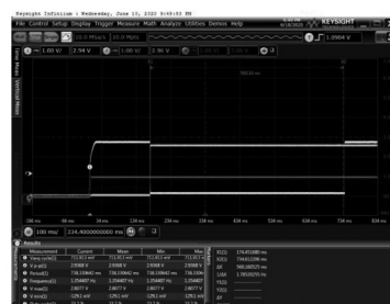
图 6 FPGA 加载配置时间长度测量结果
