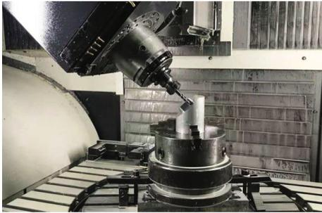
图18 BC轴混合旋转型机床加工测试
