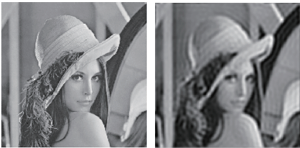
图 19 振铃效应 Fig.19 Ringing effect
