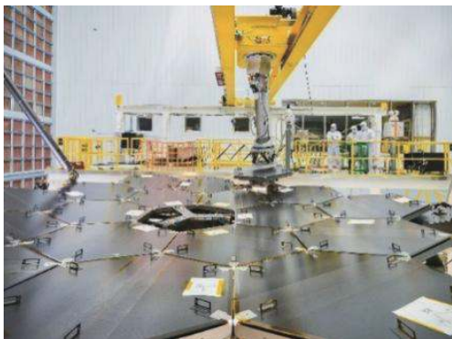
图 6 JWST 采用机器人进行主镜装调
