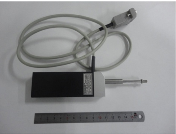
图 4 SM30 系列 ESSA 光栅位移传感器
