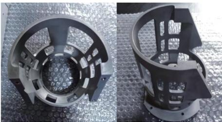
图 4 加工后的星传感器支架
