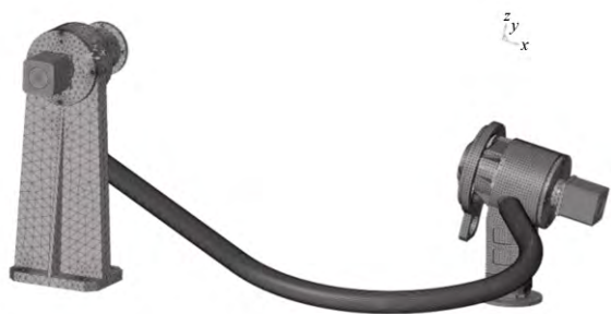
图4 双轴指向机构有限元模型
