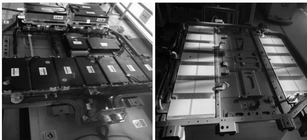
a 锂电池包封装布局 b 水管和冷板布局
