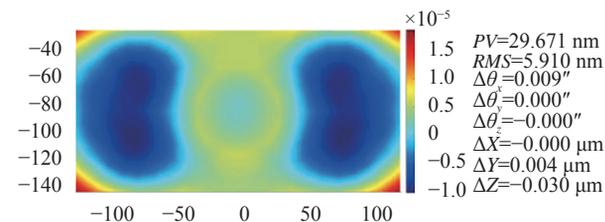
图 6 反射镜面形 PV 和 RMS 值
