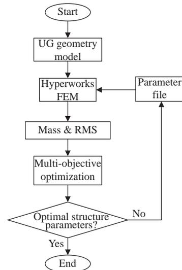
图 3 多目标集成优化流程图
