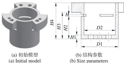
图 7 柔节结构初始模型
