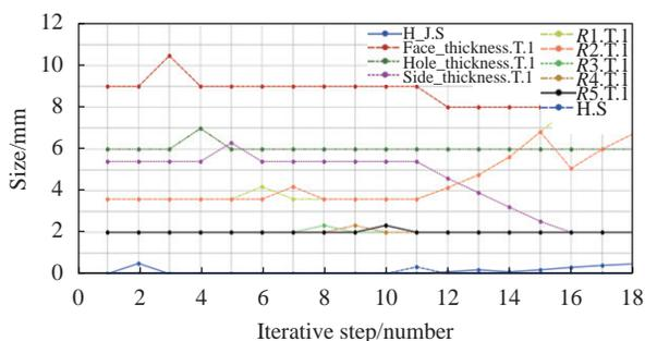
图 5 镜体结构参数迭代曲线
