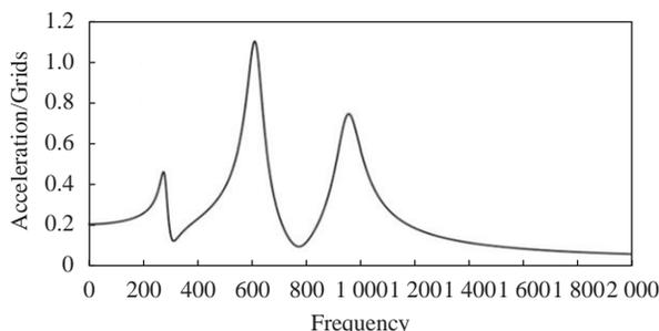
图 10 加速度频率响应曲线
