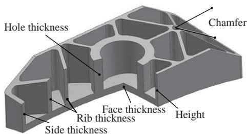
图 2 反射镜的初步设计几何结构模型
