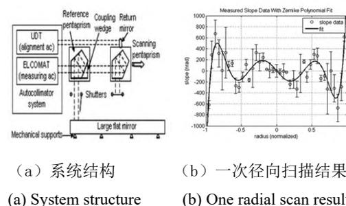
图 3 五棱镜扫描平面测量系统<sup>[5]</sup>
