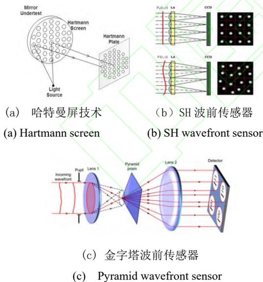
图 4 曲率/斜率波前传感器<sup>[7,8]</sup>
