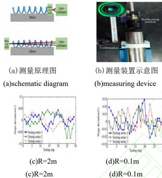
图 2 自准直法测量与不同镜反距离 R 的斜率测量结果<sup>[4]</sup>
