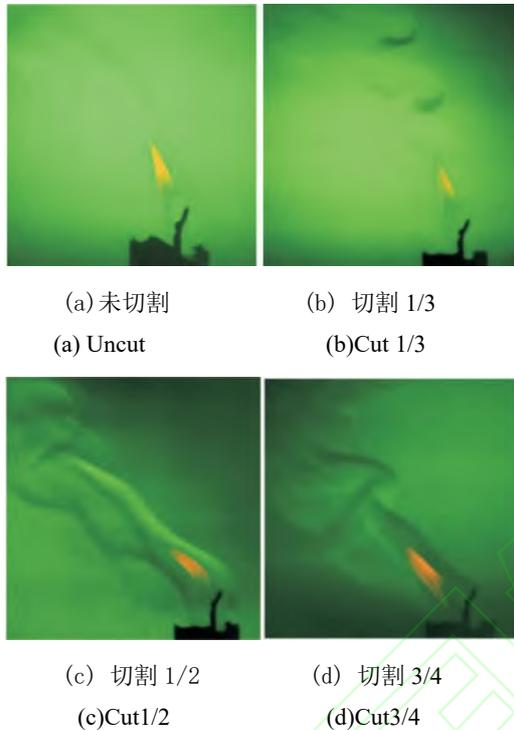
图 11 源格栅不同切割比例下的图像<sup>[34]</sup>
