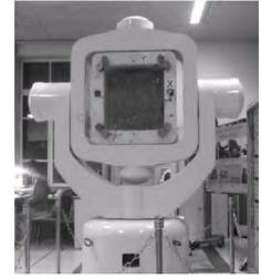
图 2: SGT-3 型三轴转台
