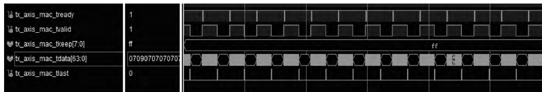
图 5 FPGA 观测发送端时序图
